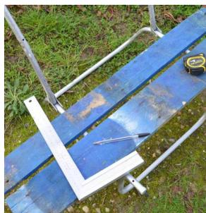
*Poncer la structure puis appliquer la peinture. Démontez des lattes de palette. Tracer vos mesures sur l'assise puis découper à la scie sauteuse.*
