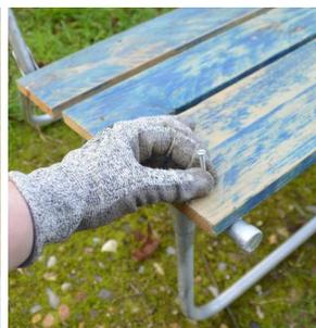
*Fixer les lattes avec les boulons + écrous. Finition: cire ou vernis (intérieur), lasure ou vernis marin (extérieur).*
